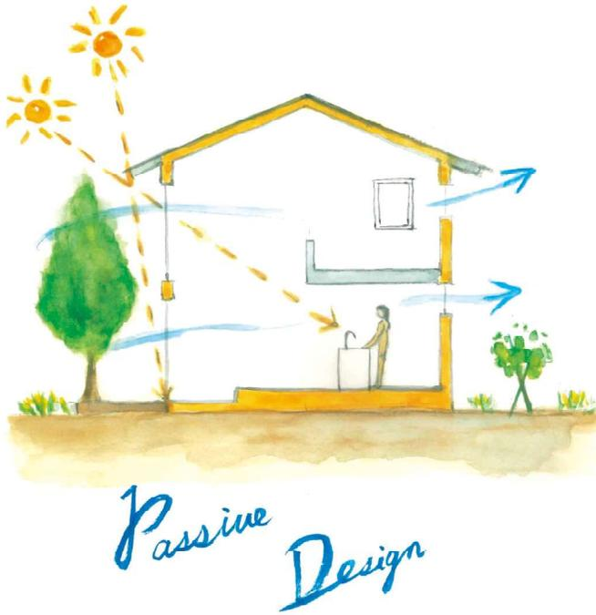
太陽光や風の流れ、雨水、地熱など自然エネルギーを、特別な機械設備を使わず建築的な技術や工夫を住まいに取り入れ、心地よい室内環境を目指す設計手法が「パッシブデザイン」。
